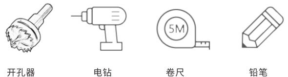
注：门锁常规安装高度为：100~120cm；开孔时需注意锁体中心线和扣板中心线水平对齐。
