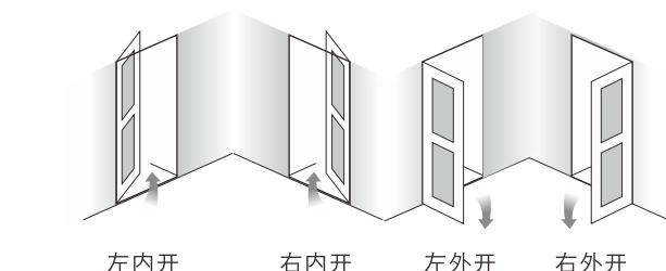
注：本智能锁适用左内开、右内开、左外开、右外开，四种开向的门。判定开门方向，人必须站在门外，正对在门前。
