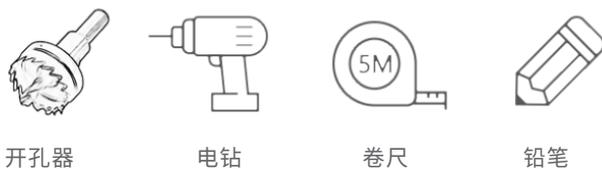
注：门锁常规安装高度为：100~120cm；开孔时需注意锁体中心线和扣板中心线水平对齐。
