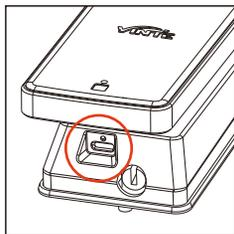
用5V移动电源连接底部应急电源口充电即可开门USB-Type-C 接口。
