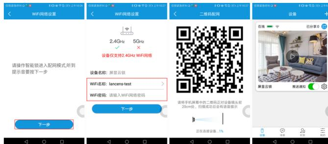
(5) 在WiFi列表中指定指定的WiFi,然后在密码栏中输入路由器的WiFi密码(注意大小写、下划线和空格),输入完成后点击“下一步”开始配网,请将手机屏幕中的二维码正对设备镜头前20cm处,扫描成功设备会提示配网成功。
