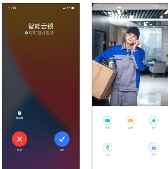
(2) 按住对讲按钮,可以向设备传输声音,可远程录像、远程拍照、远程开启。
